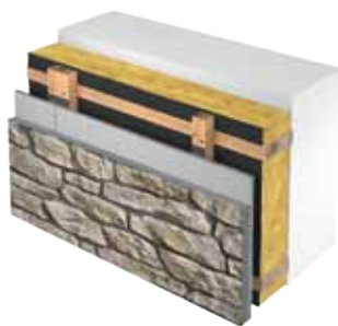
Provětrávaná předsazená fasáda s nalepeným kamenným obkladem (až do 55 kg/m²)
