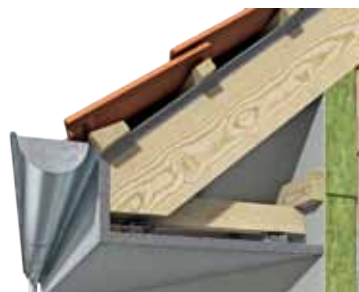
Obklad exponovaných říms, střešních štítů a soklů. Také jako pohledová deska s příznými spárami
