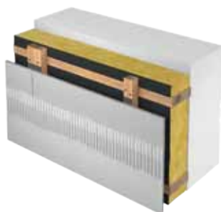
Provětrávaná předsazená fasáda s omítkovým systémem
